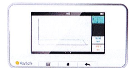
波形 独自アルゴリズムによるmAの算出結果を波形表示。
